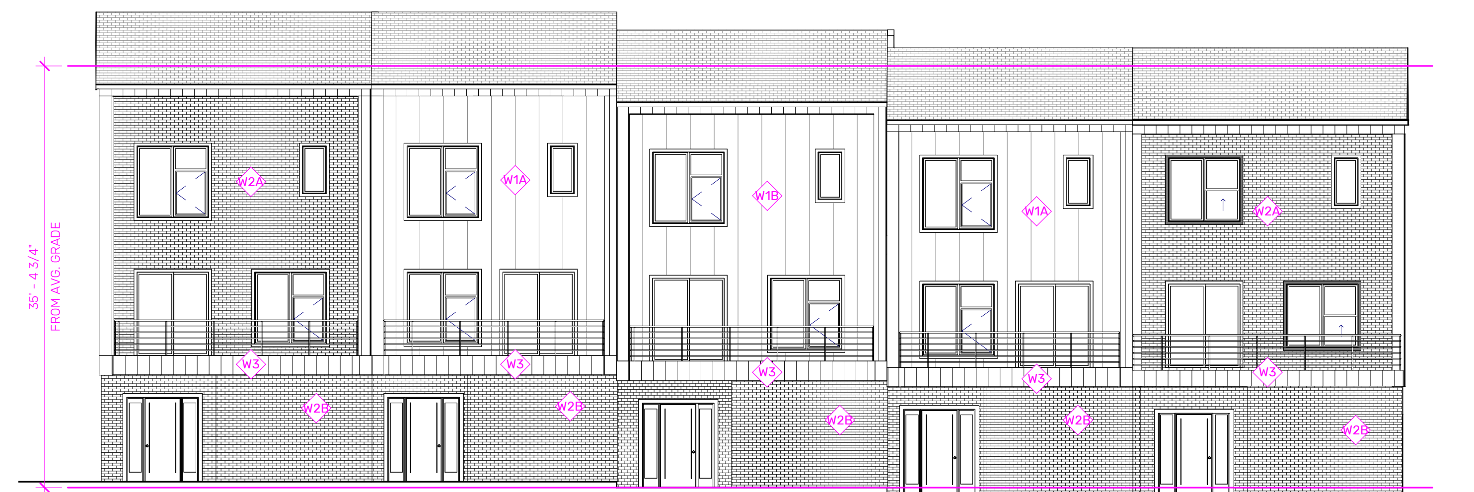
A5 BUILDING 19 - W. ELEVATION SCALE: 1/8" = 1'-0"
