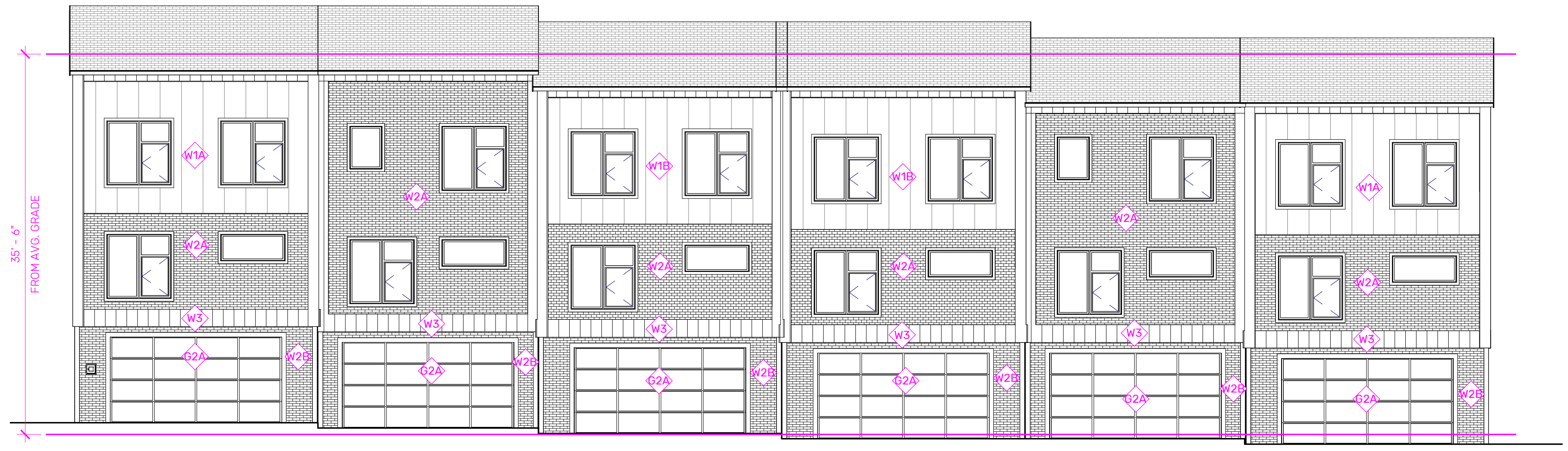
A5 BUILDING 17 - W. ELEVATION SCALE: 1/8" = 1'-0"
